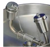
ANSI Z358.1規格の洗眼器要求、1.5Liter/min以上に対応する洗眼ヘッドです。フローコントロールゴムが内蔵されており、運転圧力0.2MPa以上で、流量を約10Liter/minの一定流量を保ちます。
