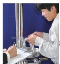
排水設備が設けられていないような環境でも、▶外に水を飛散させずに、シャワーを点検できます。
