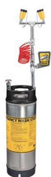
毎分1.5Literの水を数分間供給可能なポータブル洗眼器です。水をタンクに注入し、コンプレッサーエア(約0.6MPa)を加圧していく待機させておきます。タンクはステンレス製のため、耐候性、耐食性に優れています。
