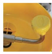
ANSI Z358.1規格の洗眼/顔器要求、11.4Liter/min以上に対応する洗眼/顔ヘッドです。フローコントロールゴムが内蔵されており、運転圧力0.2MPa以上で、流量を約11.4Liter/minの一定流量を保ちます。
