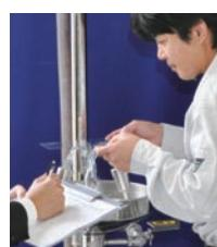
排水設備が設けられていないような環境でも、▶外に水を飛散させずに、シャワーを点検できます。
