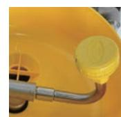
ANSI Z358.1規格の洗眼器要求、1.5Liter/min以上に対応する洗眼ヘッドです。フローコントロールゴムが内蔵されており、運転圧力0.2MPa以上で、流量を約10Liter/minの一定流量に保ちます。
