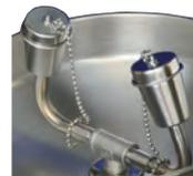
ANSI Z358.1規格の洗眼器要求、1.5Liter/min以上に対応する洗眼ヘッドです。フローコントロールゴムが内蔵されており、運転圧力0.2MPa以上で、流量を約10Liter/minの一定流量に保ちます。構成部品はすべてステンレス製です。他メーカーでは上位機種でしか選べませんが、弊社では、標準製品として量産しています。
