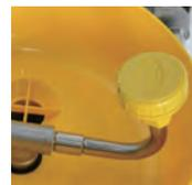
ANSI Z358.1規格の洗眼/顔器要求、11.4Liter/min以上に対応する洗眼/顔ヘッドです。フローコントロールゴムが内蔵されており、運転圧力0.2MPa以上で、流量を約11.4Liter/minの一定流量に保ちます。
